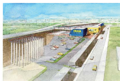
駐車場に深さ100mの地中熱交換器を70本掘削した。
