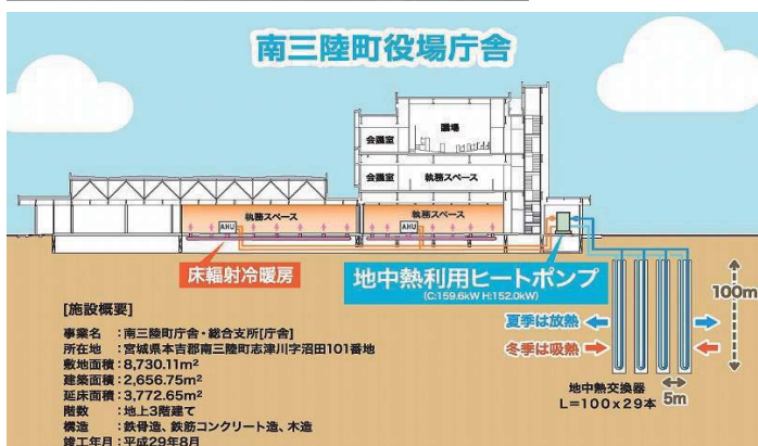
南三陸町新庁舎の地中熱システム概要 (南三陸町庁舎パンフレット(ミサワ環境技術㈱提供)より)
