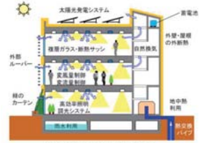
【ゼロエネルギー庁舎(イメージ図)】 官庁施設のゼロエネルギー化 モデル事業(2012-2013)
