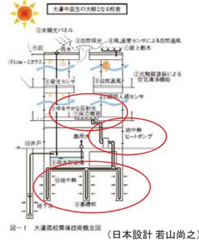
地中熱利用では、7m×84本の基礎杭を採熱管とし、冷房43kW、暖房49kWのヒートポンプを用い、床冷暖房により空気の加熱。夏は結露のない程度の床冷房をしており、ひんやりした床を体感できる。
