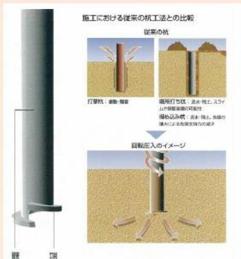
鋼管杭(新日鉄エンジニアリング資料)
